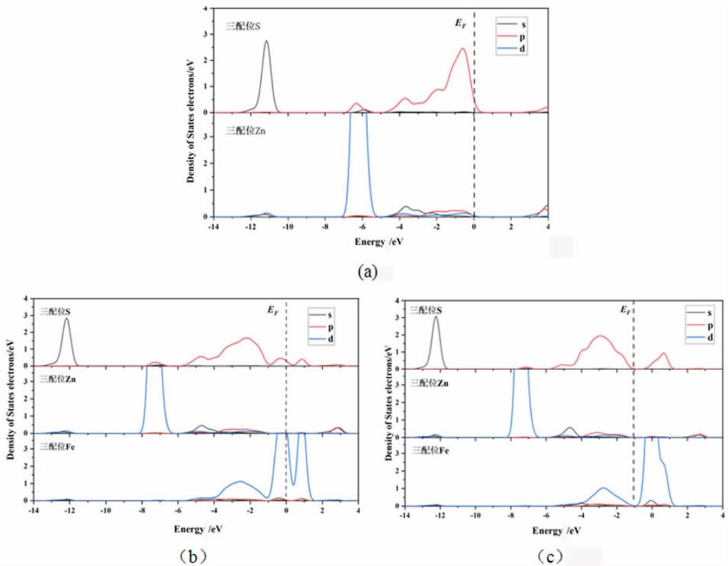
图 2 不同铁含量的闪锌矿表面态密度:(a)理想闪锌矿表面态密度 (b)高铁闪锌矿表面态密度 (c)低铁闪锌矿表面态密度
