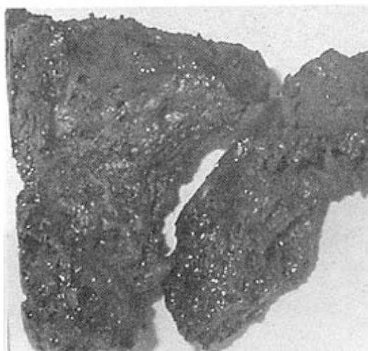
图 4 试样 E2 还原后的矿物形貌
