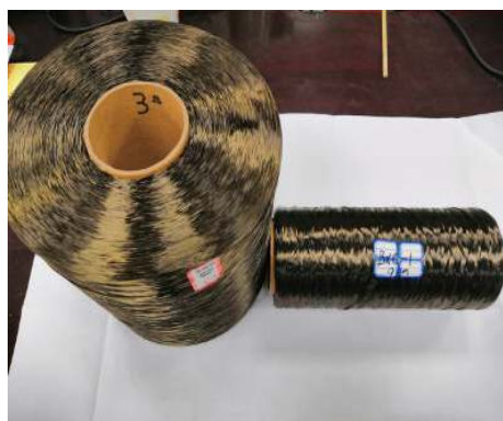
图4 乐山金口河 MZC-II 号矿体纤维加工试验样品成品及粘度-温度曲线
