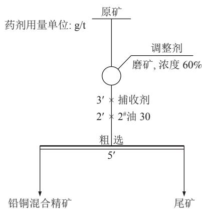
图1 单因素条件实验流程
