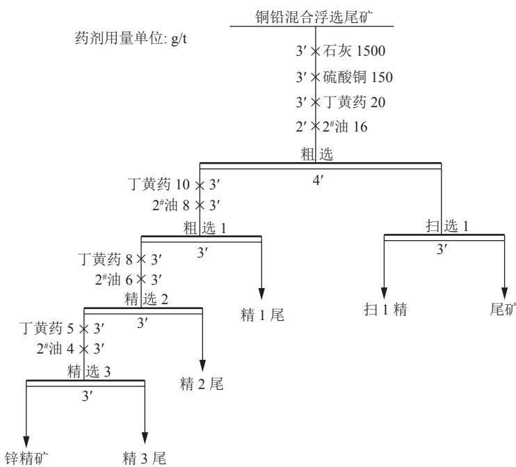
图7 铜铅混合浮选尾矿选锌开路实验流程
