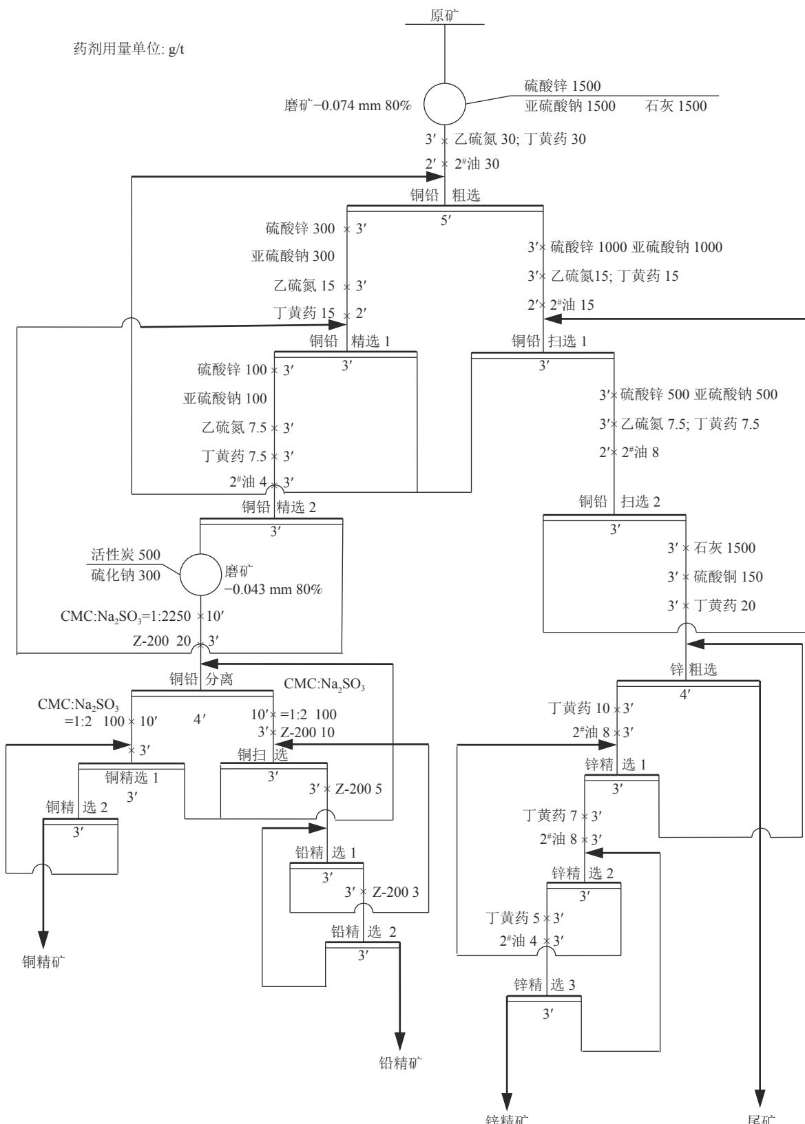
图 8 浮选闭路实验流程
