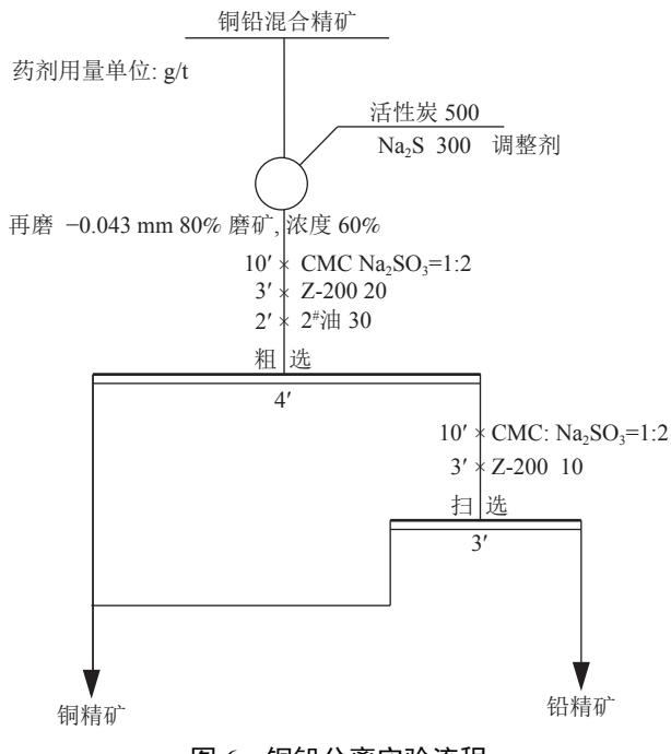
图 6 铜铅分离实验流程
