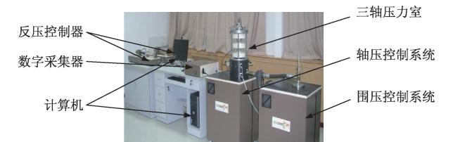
图1 GDS 高级动态三轴测试系统 Fig.1 GDS advanced dynamic triaxial test system
