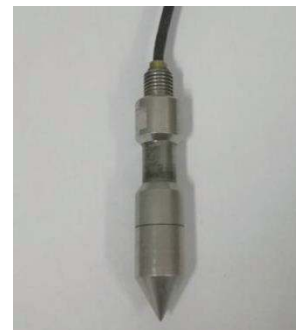
图 4 小型静力触探仪的探头 Fig. 4 Probe of small-scale static cone penetrometer
