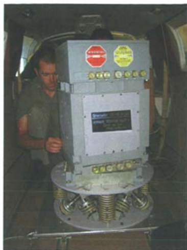
图 4 安装在机舱中的 GT-1A 型重力仪
