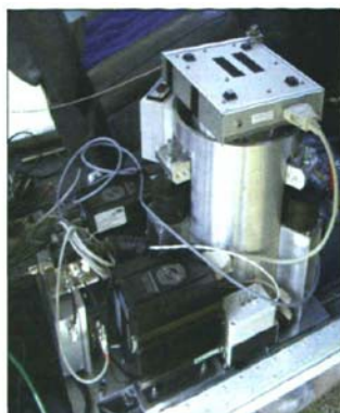
图 7 SAGS4 捷联式航空重力仪
