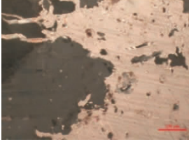
(13) 碳酸盐(右)交代钾钠长石构成交代残余结构
