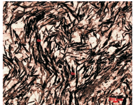
右 石墨矿石, 矿石受韧性剪切作用, 石墨 (Gr) 鳞片呈“S”型排布 薄片 (-)
