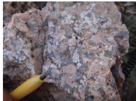
图 4 中粗粒正长花岗岩的中粗粒结构及块状构造
