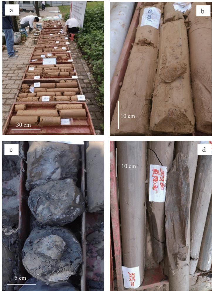
a. 92.7 m 以上黄土-古土壤序列; b. 100.5 m 位置具层理的三门组上部锈黄色细砂岩;
