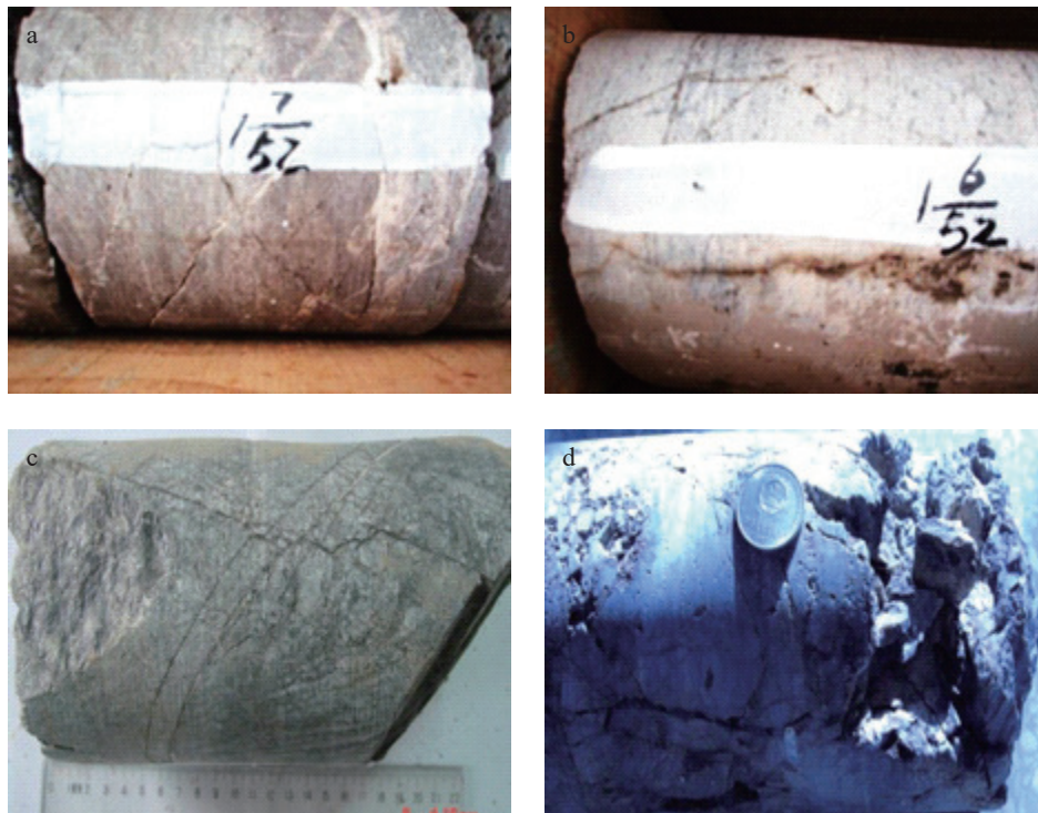
a. 栗 1 井(2 686.4 m)大理岩“X”型共轭缝; b. 栗 1(2 686.25 m)大理岩垂直缝; c. 泌 334 井(2 475.6 m)大理岩“X”型共轭缝; d. 栗 2(2 015.2 m)大理岩、溶蚀孔洞、方解石充填
