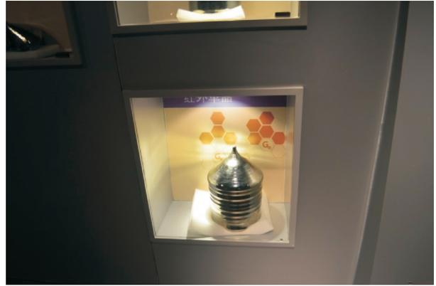
图5 国电蒙东能源公司利用粉煤灰生产的单晶锗(孙玉壮)
