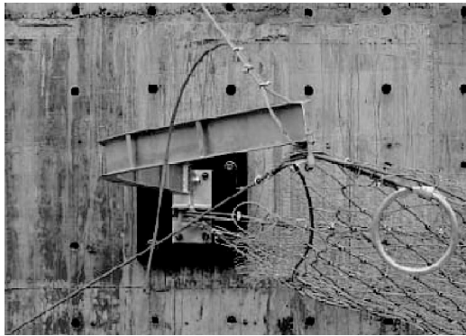
图 16 T-2 冲击试验后钢柱 1 变形图
