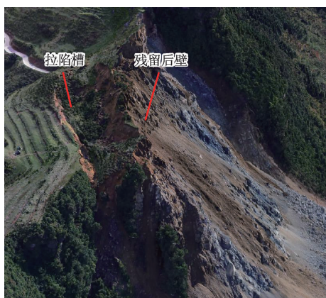
图7 崩塌源区和变形区I区
