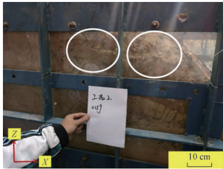
图 7 工况 2 作用下土体震陷现象
