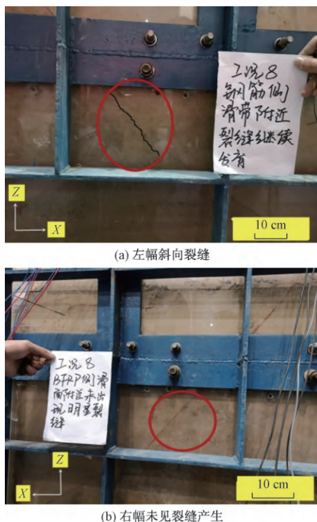
图 11 工况 8 作用下坡体变形图
