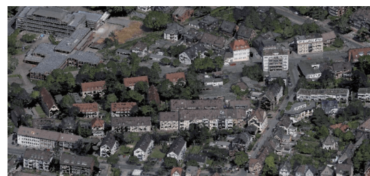
图3 高密度点云数字表面模型
