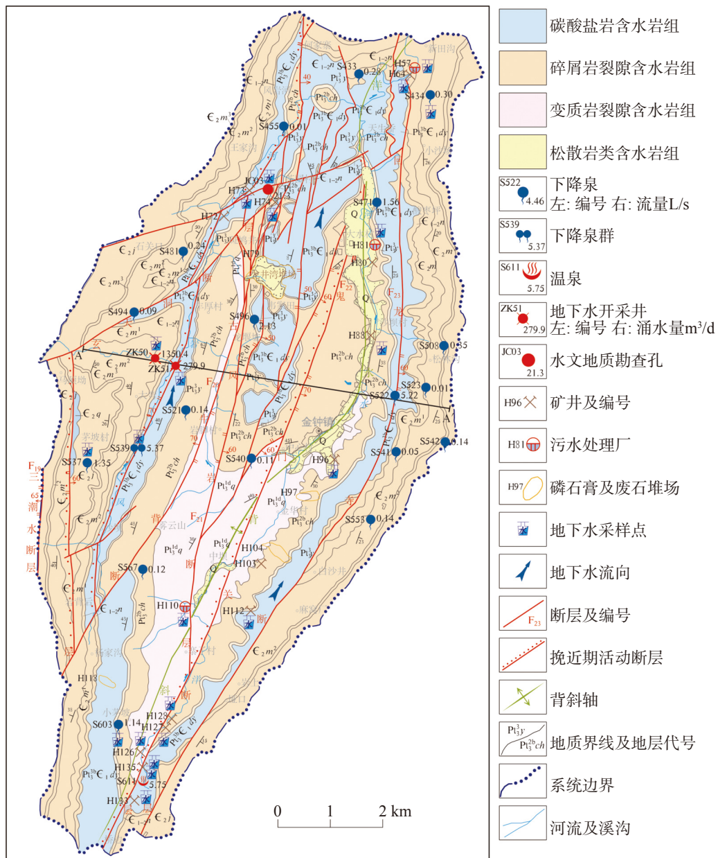
图 1 洋水背斜分散排泄系统水文地质略图
