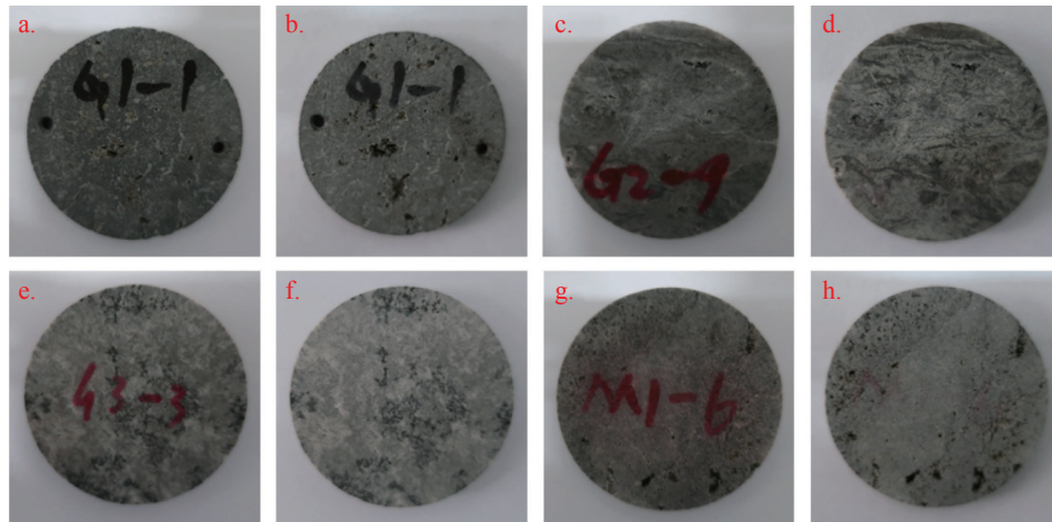
图 5 圆柱体切片样品溶蚀前后照片
