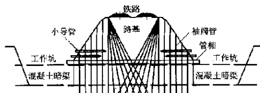
图4 暗渠两侧袖阀管注浆示意图
