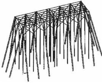
图3 平台结构有限元模型
