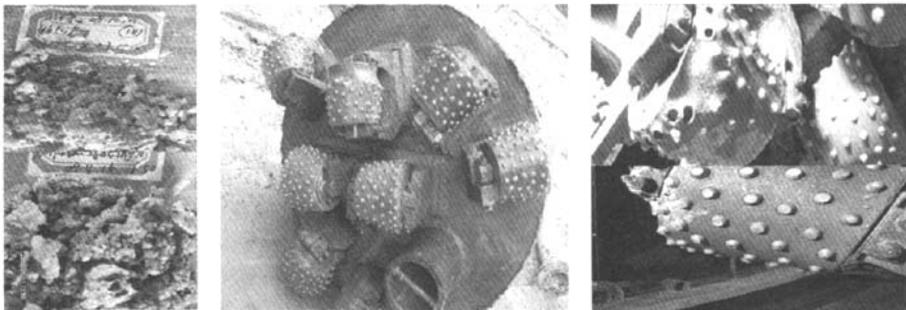
图 9 部分岩样及被磨损的钻头滚刀
