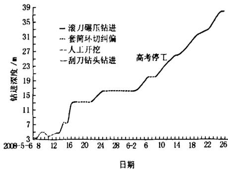
图10 A17-1孔典型成孔曲线图
