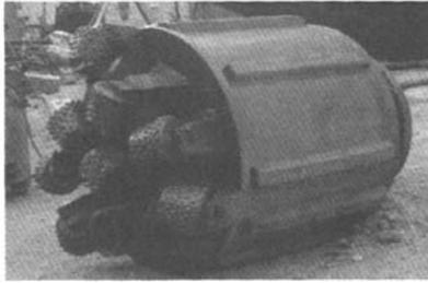
图 2 球齿滚刀钻头
