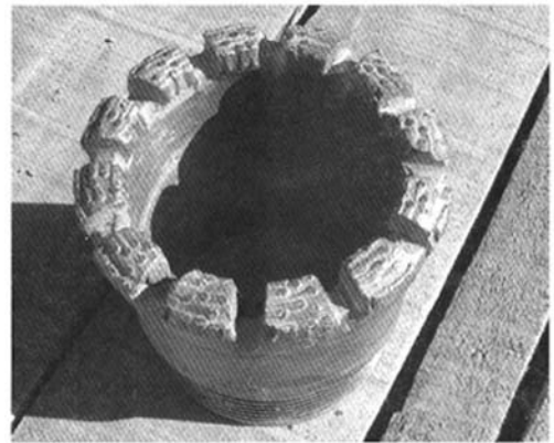
图4 孕镶金刚石-针状合金复合式取心钻头的磨损情况
