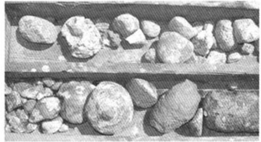
图3 孕镶金刚石-针状合金复合式取心钻头取出的部分岩心
