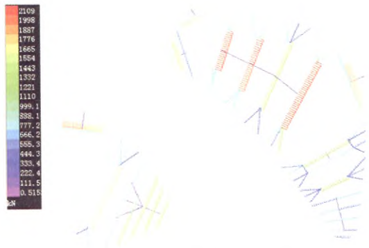
图 5 基坑支护计算内支撑轴力图
