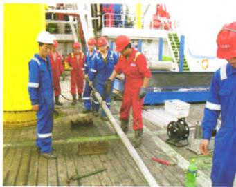
由中国地质调查局北京探矿工程研究所自主研发的 TKP-1 保压取样器具,于 2015 年 7 月底在南海陵水区块水深 804 m 及 1392 m 海域相继进行了保压取样作业试验。在总共 6 次保
