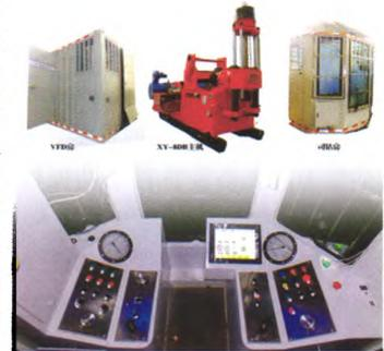
两孔施工, 核工业二七〇研究所承担的以上 2 口深孔的施工任务, 创造了国内立轴岩心钻机 P 口径 ( $\varnothing 122$  mm) 取心钻进的最深钻孔记录, 平均每米能耗约 26 元, 最高台月效率超过 500 m。该钻机是以传统立轴钻机为原型, 集成模块化交流变频电驱动及数据采集单元, 采用 PLC 与现场总线进行电气系统配置的新型节能深孔岩心钻探成套装备。相比传统机械、液压岩心钻机, 具有以下突破性优势: (1) 大幅降低深孔钻探综合成本, 尤其在 2000 m 以深钻探工程施工中表现显著; (2) 交流变频电驱动的精确检测控制性能可有效提高钻探工艺适应性, 显著提升深部钻探施工复合操控和事故处理能力; (3) 三重安全防护为深部岩心钻探提供可靠的安全防护性能; (4) 数字化、远程可视和集中操控, 显著降低地质钻探作业劳动强度, 减少人员配备。该钻机的成功应用, 标志着我国深孔新型电传动立轴岩心钻机进入实质性应用阶段, 将推动深部地质钻探工程实现由经验把握向精准预测的根本转变。
