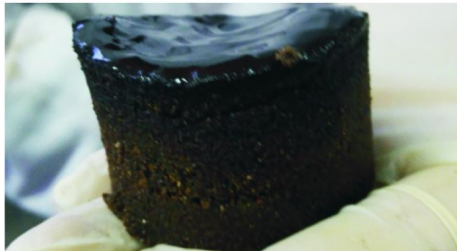
图 1 砂床表面形成的封堵层
