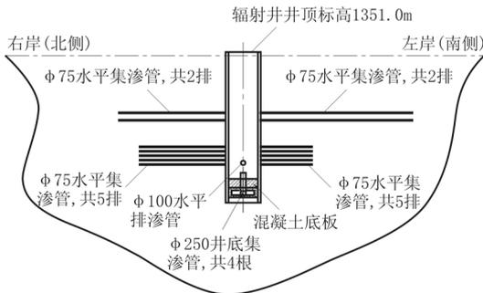
图3 辐射井纵剖面结构示意图
