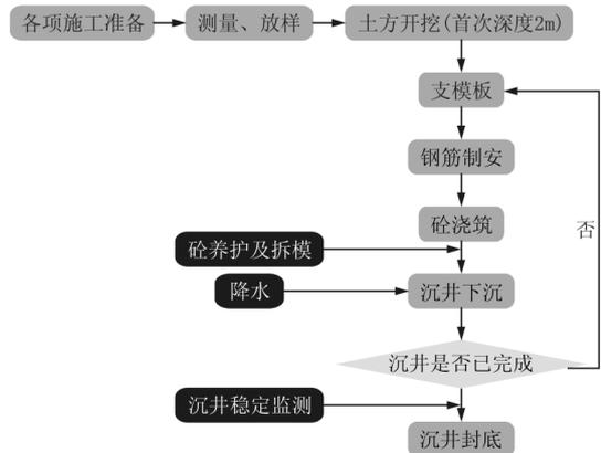
图5 沉井施工流程图
