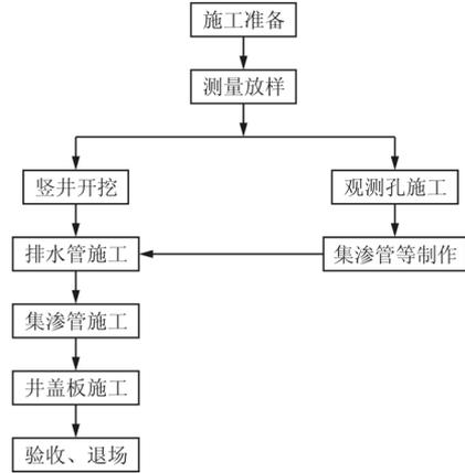
图4 项目施工总流程图
