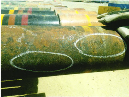
图3 本体不合格的 \text{O}168.3 mm 尾管
