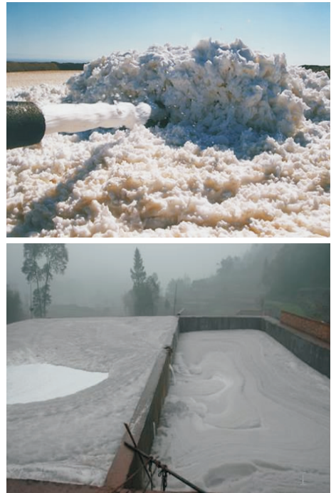
图 1 泥浆池堆满泡沫
