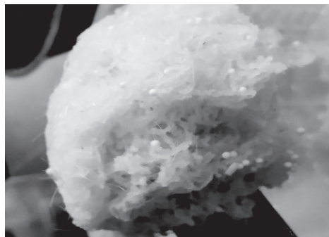
图2 温敏堵漏材料常温及温敏点以上的状态
