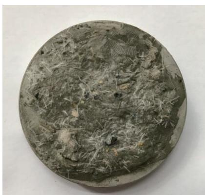
图3 3 mm孔板的封堵效果
